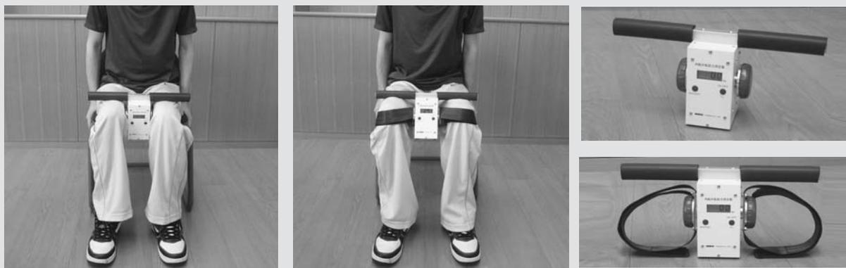
パッドを両膝で挟んで内側に力を入れることにより、内転筋群の筋力をアイソメトリックで測定します。
