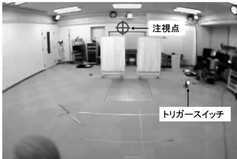
図4 障害物注視時間の算出方法 計測動画をコマ送りにしてパーテーションに注視点が停留している時間を算出した。
